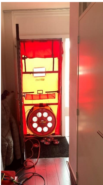
Blowerdoor (meetventilator) in de voordeur
